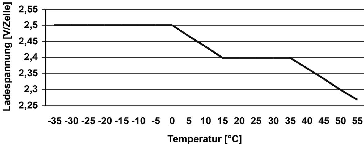
Abb 2: Temperaturabhängige Ladespannung
