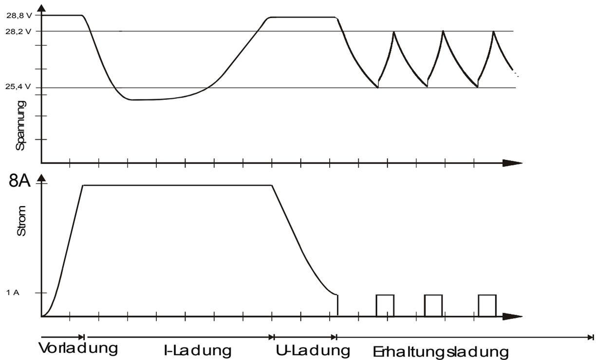
Abb 13: Ladekurve einer tiefentladenen Batterie
